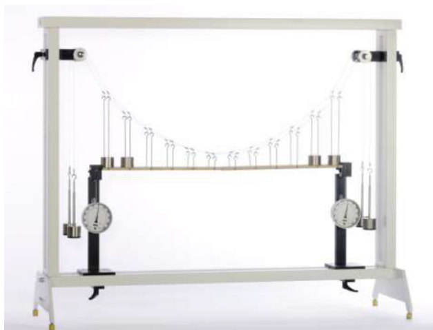
Figure 1. 1- SE.110 18. Osmo koprikdagi kuchlar eksperimental qurilmasi
