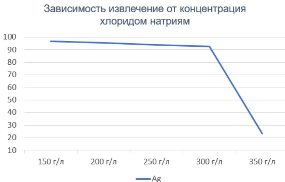
Рисунок 3. График зависимости извлечения серебра в кек от концентрации хлорида натрия (в условиях, t=75-80\text{ }^{\circ}\text{C} , T=120\text{ мин.} )
